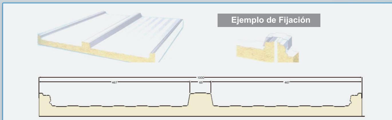
Panel metálico autoportante relleno de espuma de poliuretano, utilizado para cubiertas con una inclinación mínima del 5% sin solape, o del 7% en cubiertas con solape.
